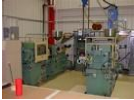
Deux (2) machines d'injection thermoplastiques
